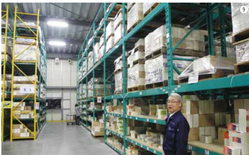
写真⑨ 固定ラックの工夫でスペース効率アップ
